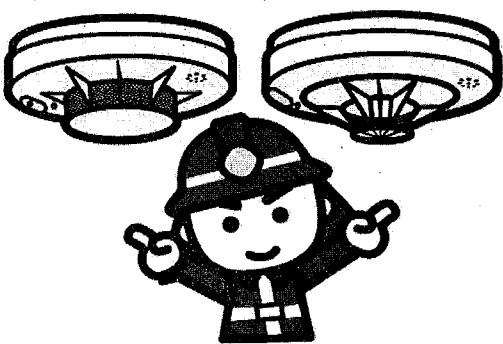
製造から約10年を経過した住宅用火災警報器は、電子部品の寿命や電池切れなどで火災を感知しなくなることがあるため、10年を目安に住宅用火災警報器本体を交換しましょう。
