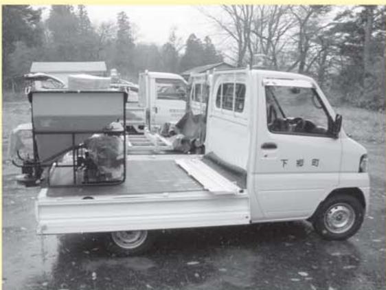
平成24年9月定例会で計上した補正予算により、軽トラックに積載するタイプの移動式凍結防止剤散布装置が導入されました。
